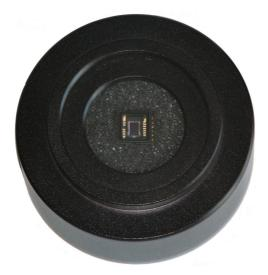
Per collegare l'autoguida al telescopio, davanti alla camera c'è un filetto T2 femmina spesso 4-5mm. Per il collegamento al focheggiatore è possibile usare qualsiasi adattatore da T2 a 31,8mm. All'interno del filetto T2, proprio davanti al sensore, è presente un filetto da 28mm per il collegamento di un eventuale filtro da 31,8mm (ad esempio per evitare che la polvere vada sul sensore).
