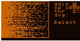
Ogni pixel mostrato corrisponde ad un campo di circa 10x10 pixel suppa superficie del CCD, la sua luminosità viene derivata da questi. Il metodo di calcolo della luminosità viene descritto più avanti.
